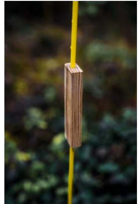
Abbildung 3b: Verlängerung zweier Markierungsstäbe aus Fiberglas (hier: Vinotto©) mit einem Kupplungsstück auf 260 cm. Foto: Ansgar Scheffold
