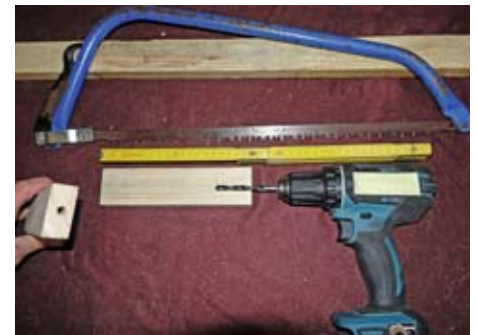
Abbildung 3a: Das Kupplungsstück lässt sich mit herkömmlichen Dachlatten (24 x 48 mm), Säge sowie einer Bohrmaschine (7mm Bohrer) einfach anfertigen. Das Modell einer Metallhülse ist in Entwicklung. Foto: Autor
